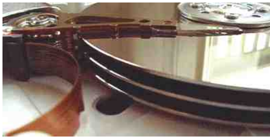
Gambar 1: Platter dan lengan pembaca pada sebuah hard disk
